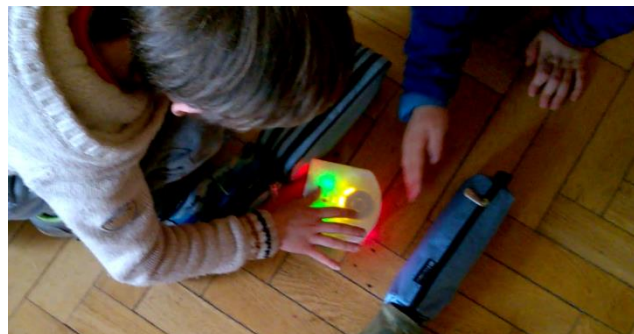
Par exemple en mode "obéissant", si Thymio détecte un objet devant lui, alors il avance...
